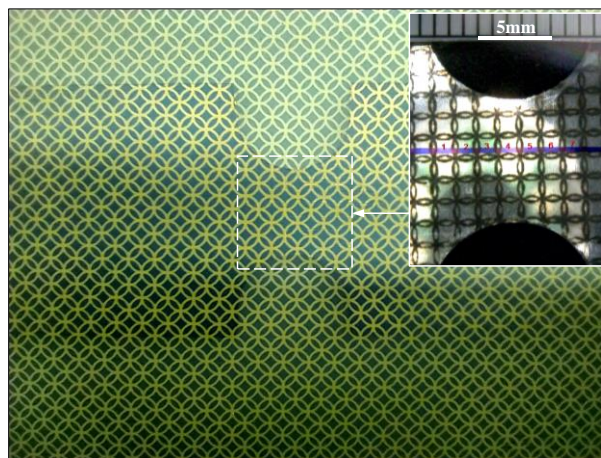
FIGURA 3.24 - Impressão eletroquímica da grade de círculos secantes ( d_0 = 2,0\text{ mm} ) (o autor, 2022).
