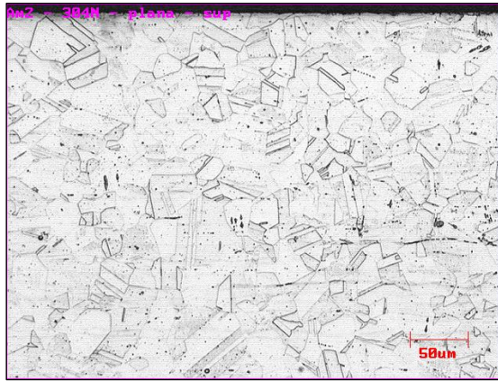
FIGURA 4.1 - Micrografia da chapa de aço AISI 304 (ataque com reagente Behara) (o autor, 2022).
