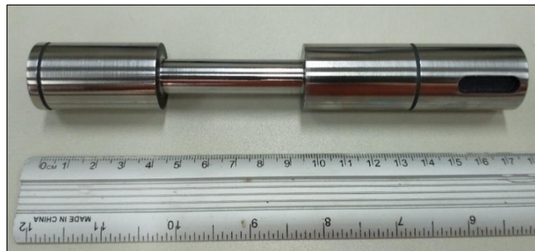
FIGURA 3.9 - Imagem de um dos pinos de dobramento ( R = 6,5 mm) fabricados em aço DIN 1.2990 para execução dos ensaios de validação do tribossimulador (Grupo 1) (o autor, 2022).
