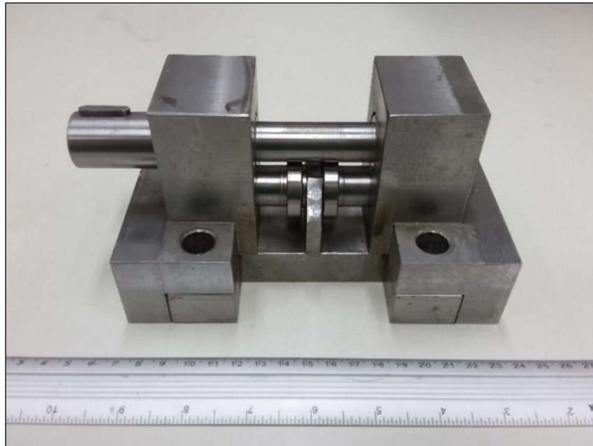
FIGURA 3.10 - Imagem mostrando o porta-ferramentas para o pino móvel fabricado em aço DIN 1.2990 (o autor, 2022).
