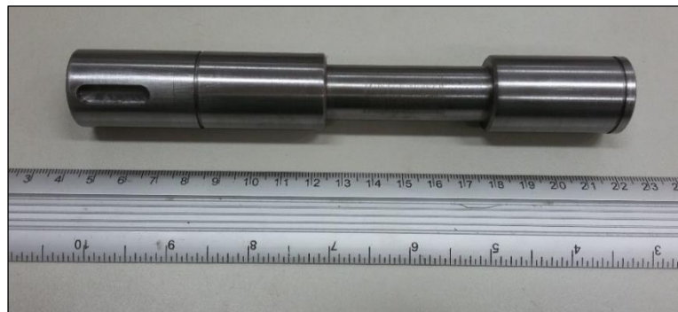
FIGURA 3.13 - Pino de dobramento ( R = 9,0 mm) fabricado em metal duro ultrafino TSF44 para execução dos ensaios de conformabilidade do Grupo 2 (BUT e STT) (o autor, 2022).
