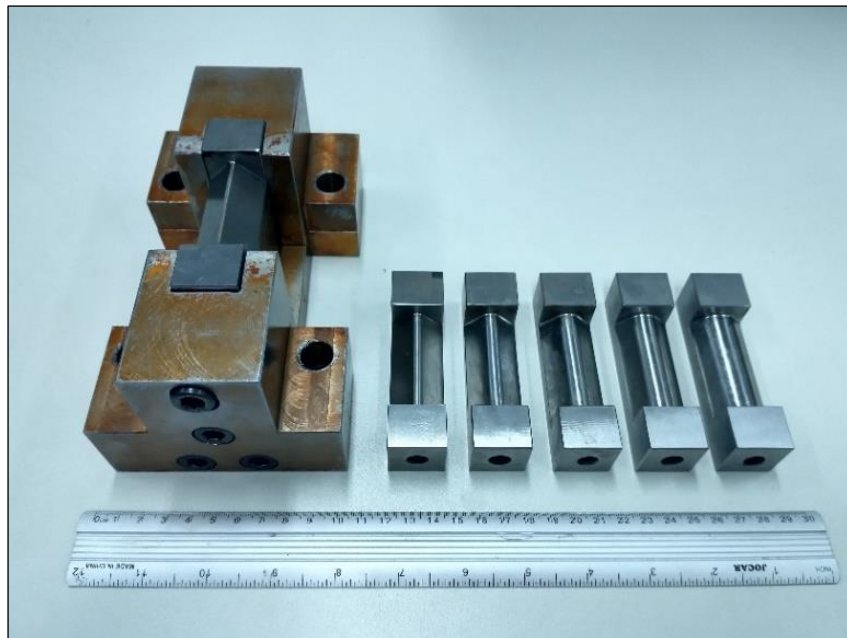
FIGURA 3.15 - Imagem mostrando o porta-ferramentas e alguns pinos que foram fabricados em aço AISI O1 (o autor, 2022).
