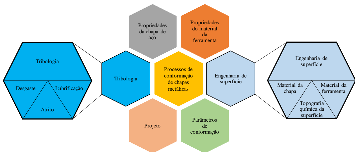
FIGURA 2.10 - Fatores que influenciam na conformabilidade da chapa metálica (adaptado de EVIN et al. , 2016).
